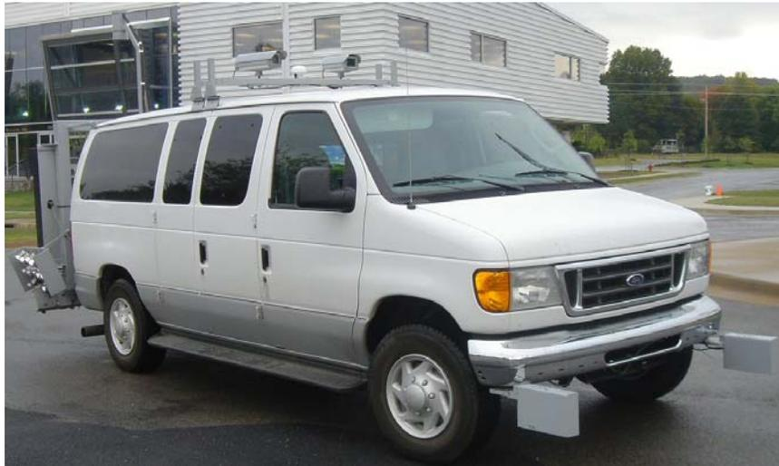
**FIGURE 6** the DHDV(Digital Highway Data Vehicle).
